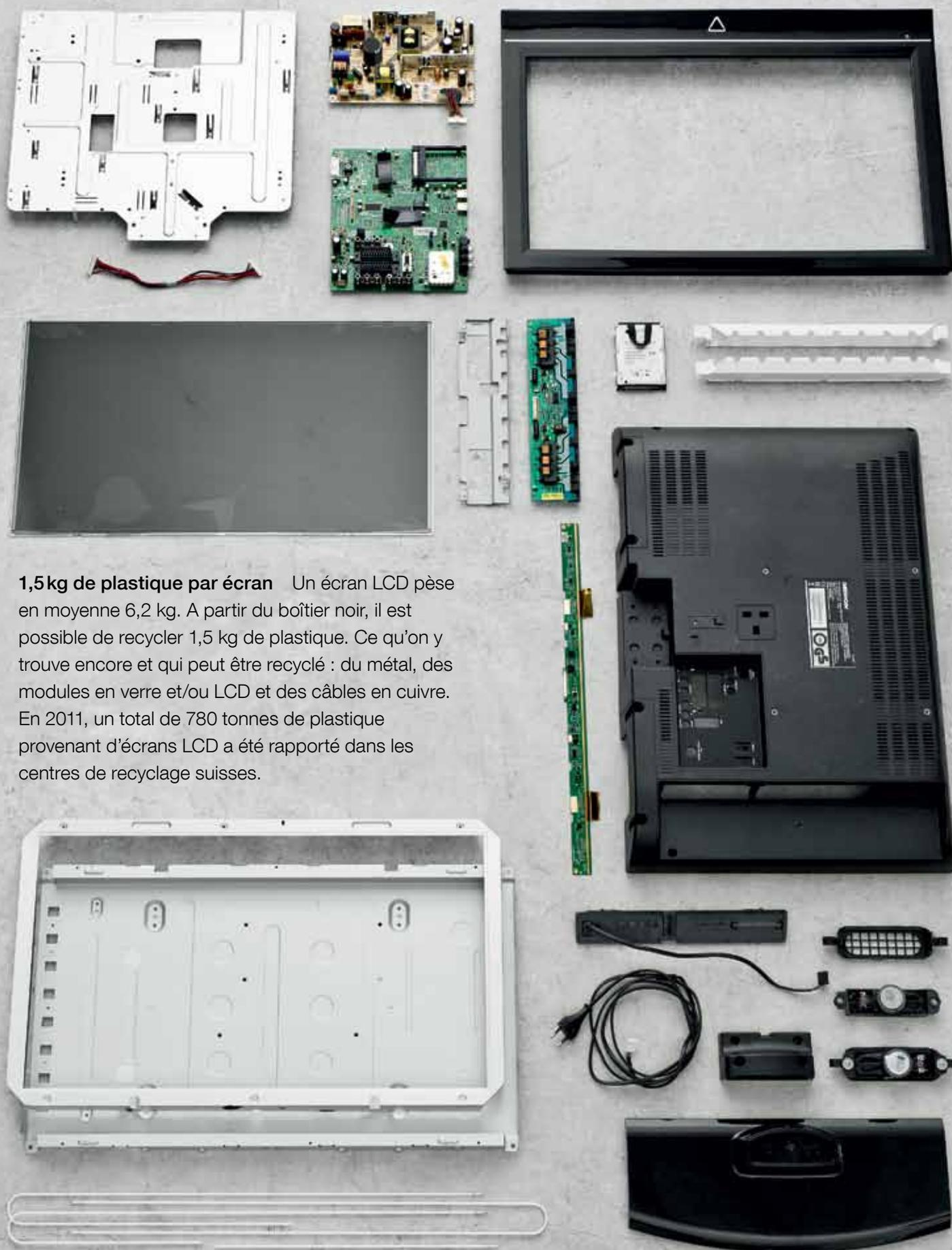
**1,5kg de plastique par écran** Un écran LCD pèse en moyenne 6,2 kg. A partir du boîtier noir, il est possible de recycler 1,5 kg de plastique. Ce qu'on y trouve encore et qui peut être recyclé : du métal, des modules en verre et/ou LCD et des câbles en cuivre. En 2011, un total de 780 tonnes de plastique provenant d'écrans LCD a été rapporté dans les centres de recyclage suisses.
