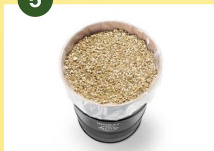
Après la dernière couche d'accus Li-ion et de piles Li, les recouvrir d'une couche de vermiculite.
