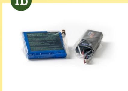
**Alternativement** ou en complément au ruban adhésif, les accus Li-ion et les piles Li peuvent également être placés dans un sac en plastique, afin d'éviter des courts-circuits.
