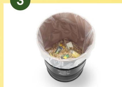
Une première couche de vermiculite est mise en place dans le fût.
