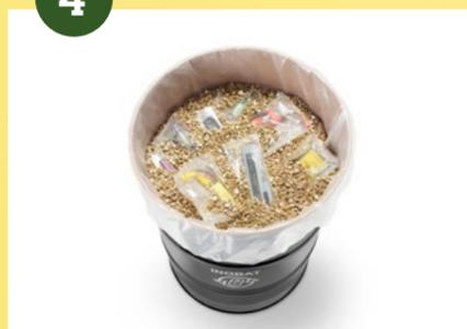
Une couche de vermiculite est versée sur chaque couche d'accus Li-ion et de piles Li. Ce processus est répété jusqu'à ce que le fût soit plein.
