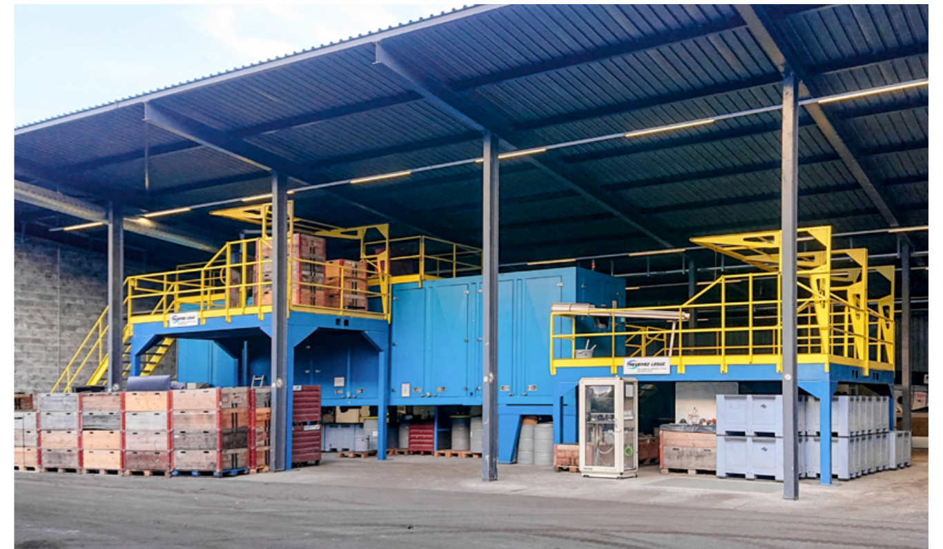
Endfraktionen und Vormaterial zur weiteren Verarbeitung auf der optischen Sortieranlage
