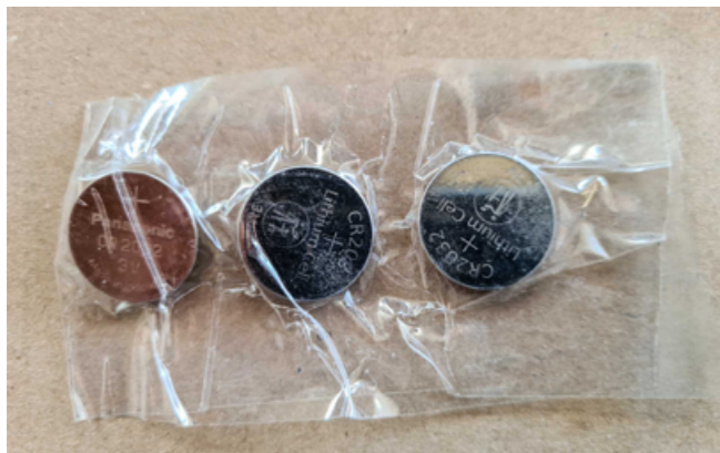
Abgeklebte Lithium-Knopfzellen verhindern bei grösseren Mengen Kurzschlüsse (Foto: soRec)
