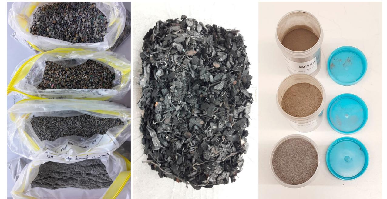
Abbildung 5: Beispiele aufbereiteter Proben (v. l. n. r.): Siebfraktionen unterschiedlicher Korngrößen von gemahlene Leiterplatten (LP), welche der Untersuchung der Verteilung verschiedener Stoffe (insbesondere von Edelmetallen) in den verschiedenen Matrizen dienen; pyrolysierte LP-Fraktion, aus der alle flüchtigen Bestandteile entfernt und in Lösungen abgeschieden und untersucht wurden; in Kryomühle erzeugte Mahlfractionen (v. u. n. o: Kunststofffraktion, Nasswäscherschlamm, RESH).
