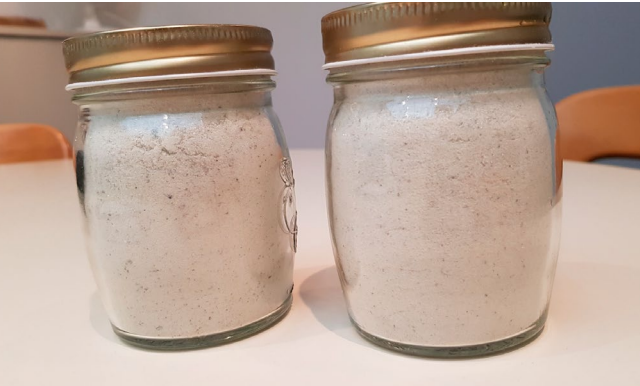
Photo 2: fractions de matériaux sortants. Poudre de polyuréthane.
