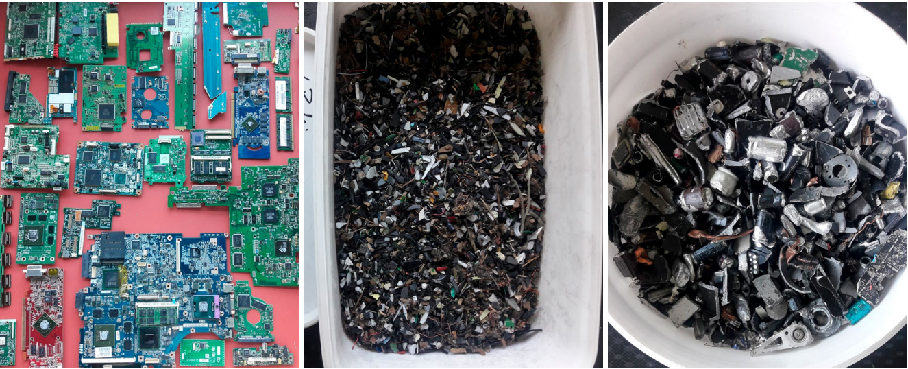
Figure 4: exemples de fractions générées (de gauche à droite): circuits imprimés de la classe 1, après le démontage fin, obtenus à partir d'appareils électroniques modernes; fractions de matières plastiques extraites dans l'essai par lots avec une forte teneur en métaux précieux (importante proportion de circuits imprimés); fraction d'aluminium obtenue dans l'essai par lots avec un séparateur à courants de Foucault. On peut distinguer de nombreux condensateurs électrolytiques qui ont, certes, été un peu abîmés à l'ouverture, mais qui ont été pratiquement tous séparés dans cette fraction.
