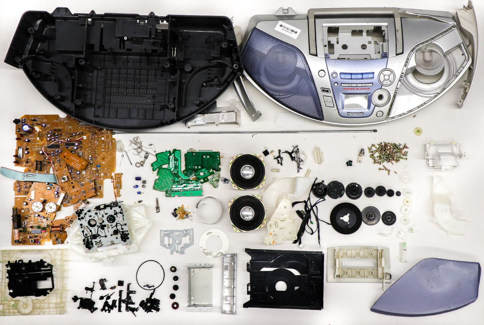
Figure 3: ghettoblaster après un démontage fin.
