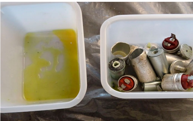
Photo 1: séparation de solides et liquides au bout d'une période d'écoulement de quatre mois.
