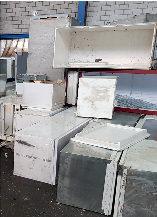
Foto 2: Kühlgeräte vor der Verarbeitung auf Stufe 2 (Shredding mit Rückgewinnung der Treibmittel).
