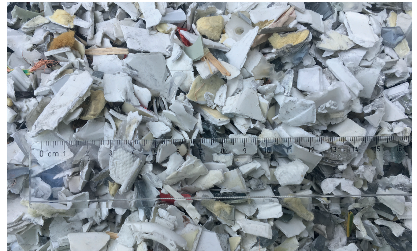
Foto 2 und 3: Beprobung von Kunststoffen aus Haushaltsgrossgeräten zur Bestimmung der Schadstoffgehalte (Bilder: Arthur Haarmann).
