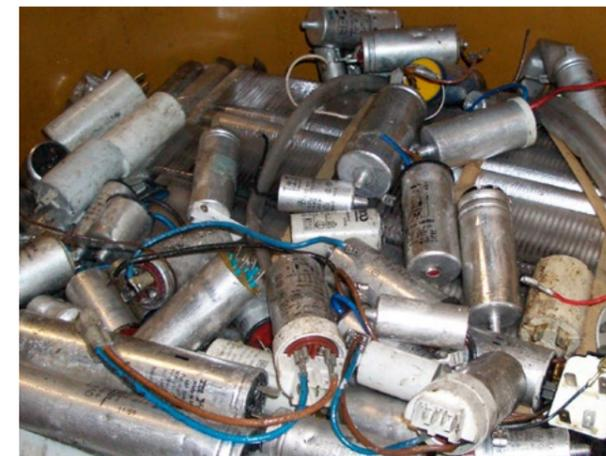
Figure 1: condensateurs mélangés issus d'appareils électriques éliminés.
