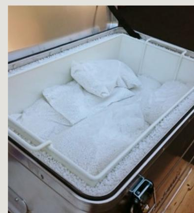
Figure 3: les récipients de collecte certifiés UN sont soulevés hors des récipients de transport et y sont redéposés à l'aide de sangles de transport.
