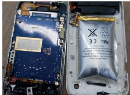
*Defekte Lithiumbatterie in einem Handy: In loser Schüttung gesammelt steigt die Explosions- und Brandgefahr um ein Vielfaches. Bildquelle: Sorec*
