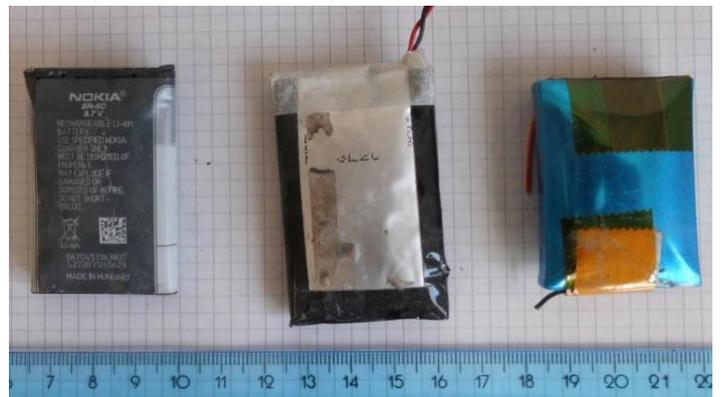
Oben: Beispiele für beschädigte und geblähte Pouch-Zellen (Lithium-Ionen Batterie).
