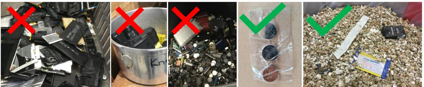
Achtung Kurzschlüsse! Auch bei Zwischenlagerung den Kontakt zwischen den LiB-Polen oder LiB mit Metall vermeiden, z.B. mit Vermiculit. Grosse Mengen Knopfzellen zusätzlich unten und oben mit Klebeband abdecken.
