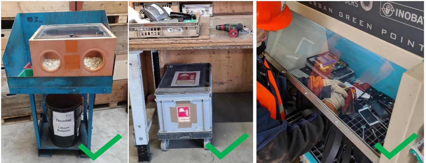
Beispiele für die Gestaltung spezieller LiB-Demontageplätze mit geeignetem Werkzeug, LiB-Zwischenlagerung, griffbereiten Behältern zur Isolation von suspekten oder gefährlichen LiB oder Abzugshaube.
