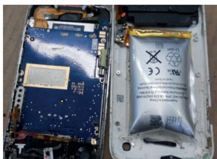
*Batterie au lithium défectueuse dans un téléphone mobile: lors d'une collecte en vrac, le danger d'explosion et d'incendie se multiplie. Source: Sorec*
