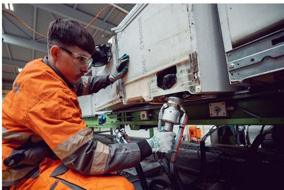
Abb. 2: Absaugen der Kältemittel bei der Immark AG in Aarwangen (Stufe 1). Bildquelle: Immark AG
