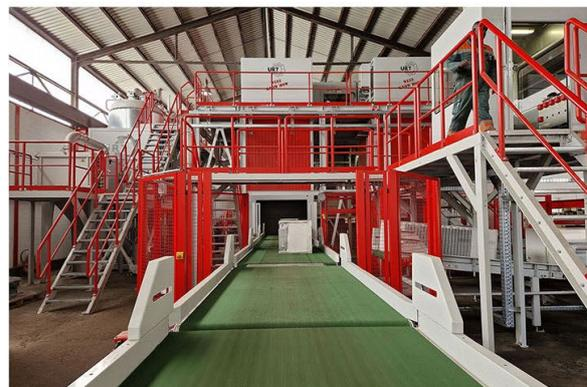
Abb. 3: Verarbeitung der Gehäuse in gasdichtem Shredder bei der E. Flückiger AG in Rothrist (Stufe 2). Bildquelle: E. Flückiger AG
