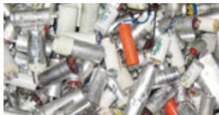
SWICO Recycling, la fondation SENS Suisse et la fondation SLRS pour le recyclage des luminaires ont ordonné une étude sur les PCB. L'objectif était de connaître le nombre de condensateurs contenant des PCB encore en circulation et si les processus de recyclage devaient être adaptés. L'Empa St-Gall s'est chargé de l'enquête en collaboration avec l'office de chimie environnementale. L'étude mon-
